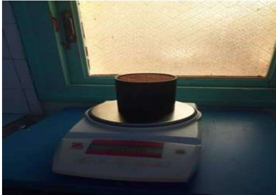
صورة 11 :لوزن التربة داخل القالب المعدني
