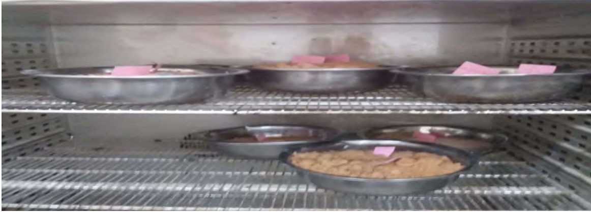
صورة 03: توضيح تجفيف العينات في المجفف.
