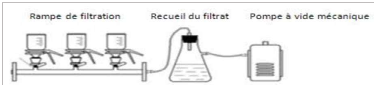
Figure III.1 : Adsorption sur charbon actif (ou sur un autre adsorbant).
