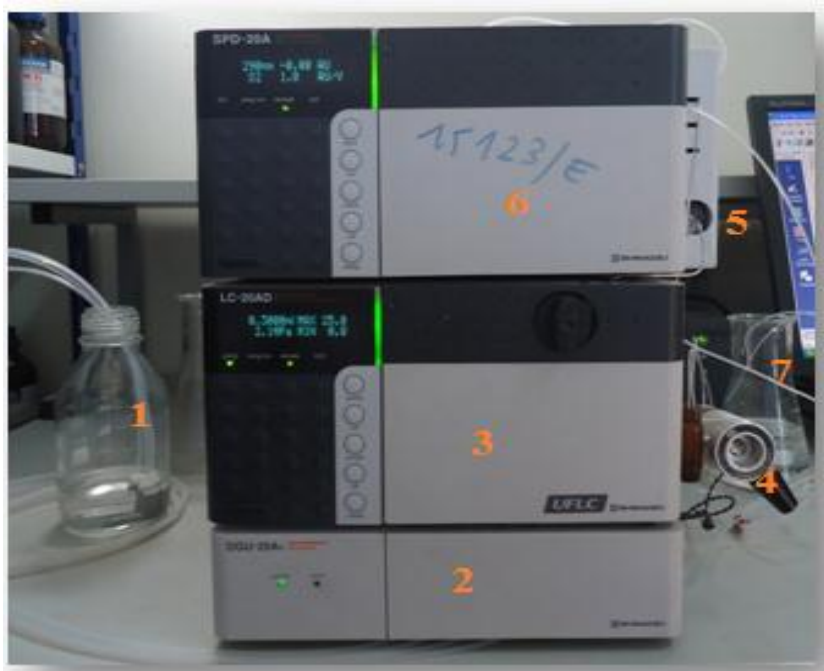
Figure IV.2. Les organes d'une chaîne CLHP SHIMADZU LC-20A isocratique
