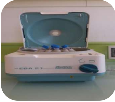
الصورة. II.6: فصل المحلول عن الطين بجهاز الطرد المركزي
