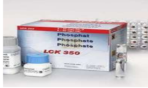
الشكل (19) : صور للوسائط المستعملة في الكشف عن الفسفور الكلي الموجود في الحمأة
