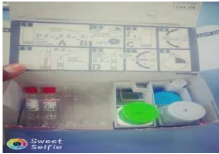
الشكل (20) : صور للوسائط المستعملة في الكشف عن نسبة النيتروجين الكلي الموجود في الحمأة
