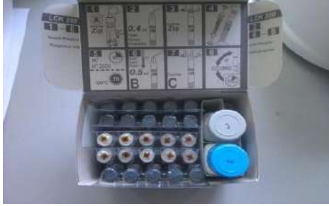
الشكل (19) : صور للوسائط المستعملة في الكشف عن الفسفور الكلي الموجود في الحمأة
