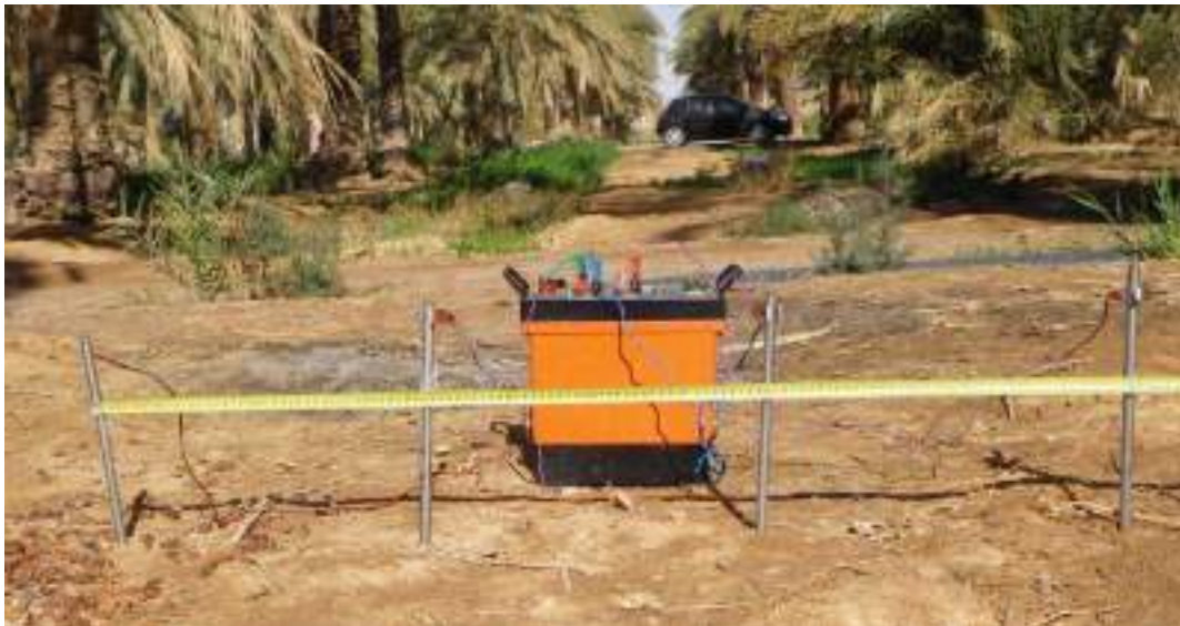
Figure 4. Résistivimètre électrique selon le dispositif Wenner.
