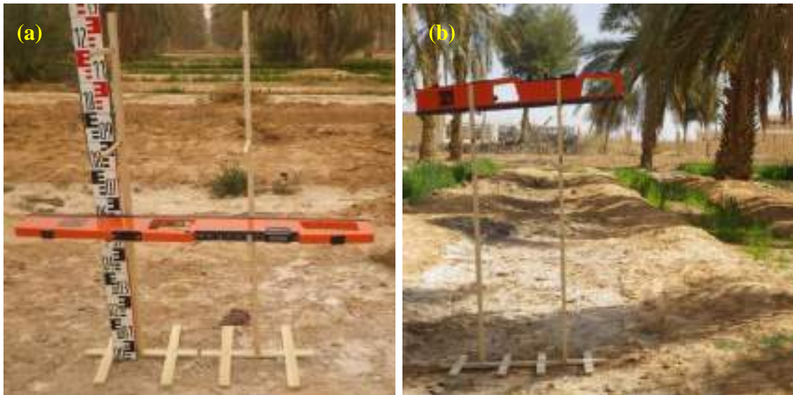
Figure 1. Position de l'EM38 : (a) horizontale soulevé de 60cm de la surface du sol ; (b) verticale soulevé de 120cm de la surface du sol.
