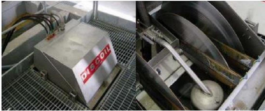
Figure (6) : déshuileur flottant à disque rotatifs(Discoil) MS-107. (22/042019)
