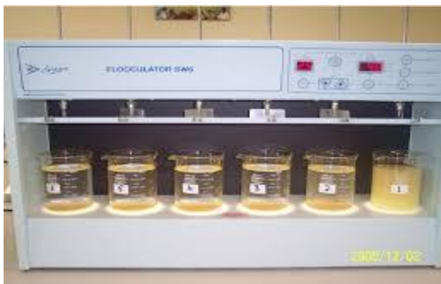
Figure (12) : Les échantillons sous l'appareille JAR-TEST
