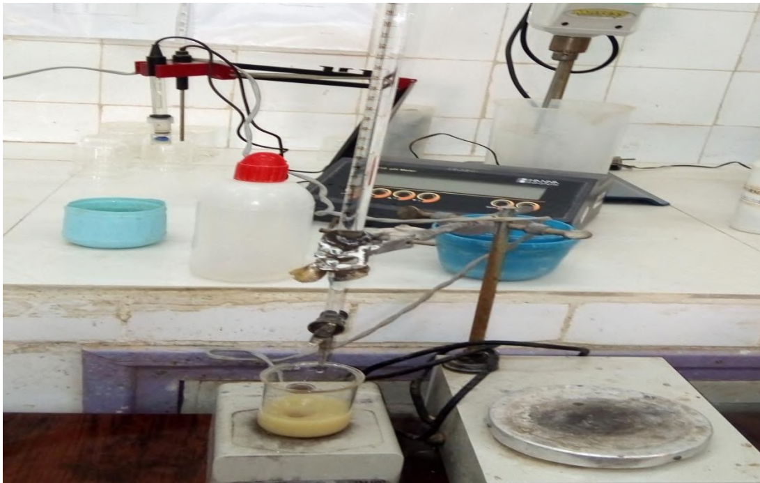
صورة (8): عملية معايرة الكلوريد بواسطة نترات الفضة.
