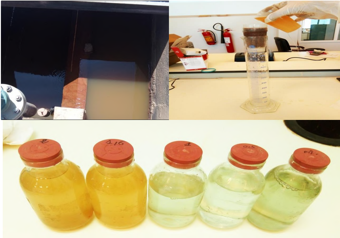
صورة (10): أخذ العينات وترشيحها بواسطة الكرناف.
