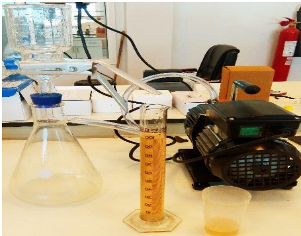
صورة (14): التركيب التجريبي لعملية الترشيح تحت الفراغ.
