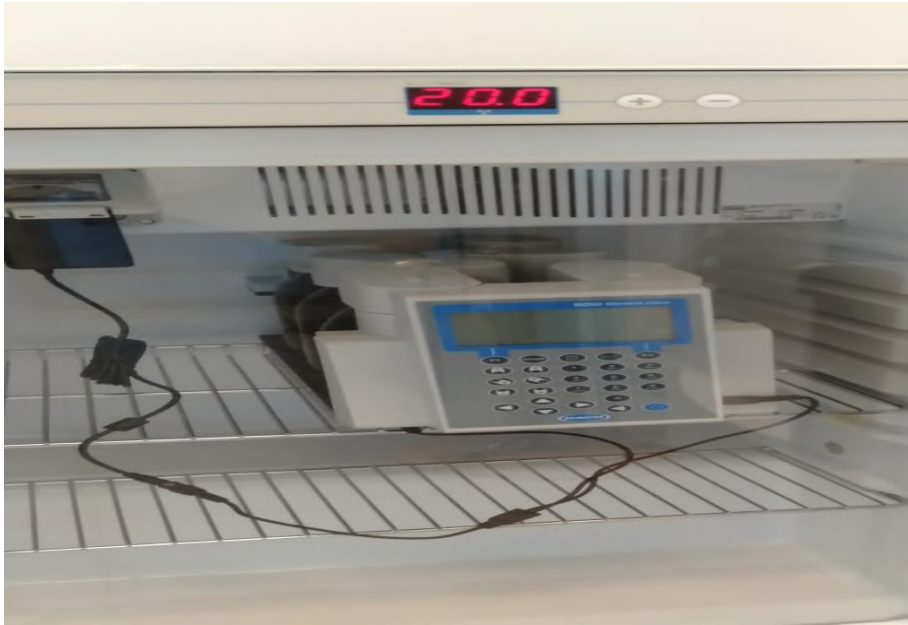
صورة (15): جهاز HACH BOD TRAK المستخدم لقياس DBO_5 .
