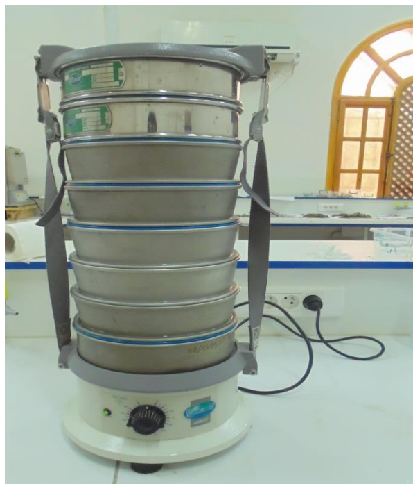
Fig. 4. Appareil de granulométrie (tamis avec tamiseur)
