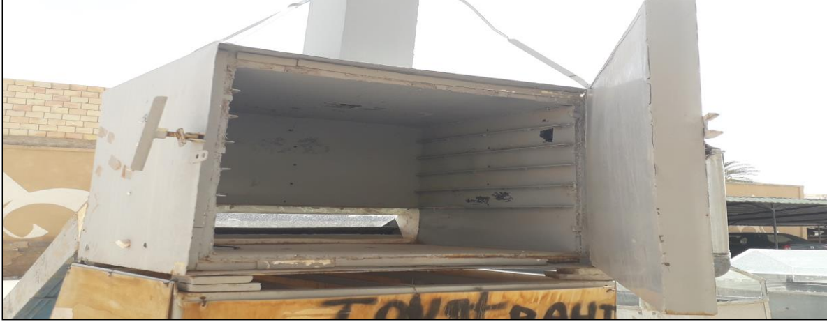
الشكل ( II - 2) وحدة التجفيف
