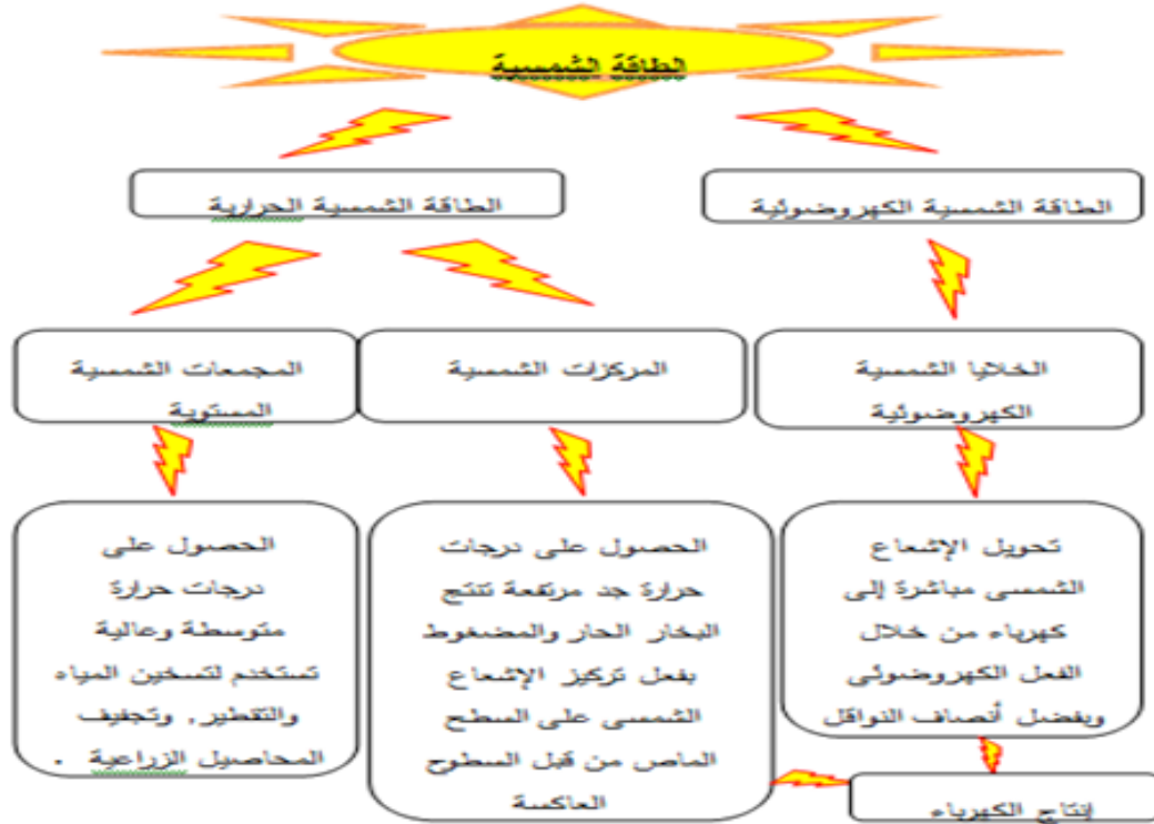
الشكل II-1: مخطط يوضح استخدام الطاقة.
