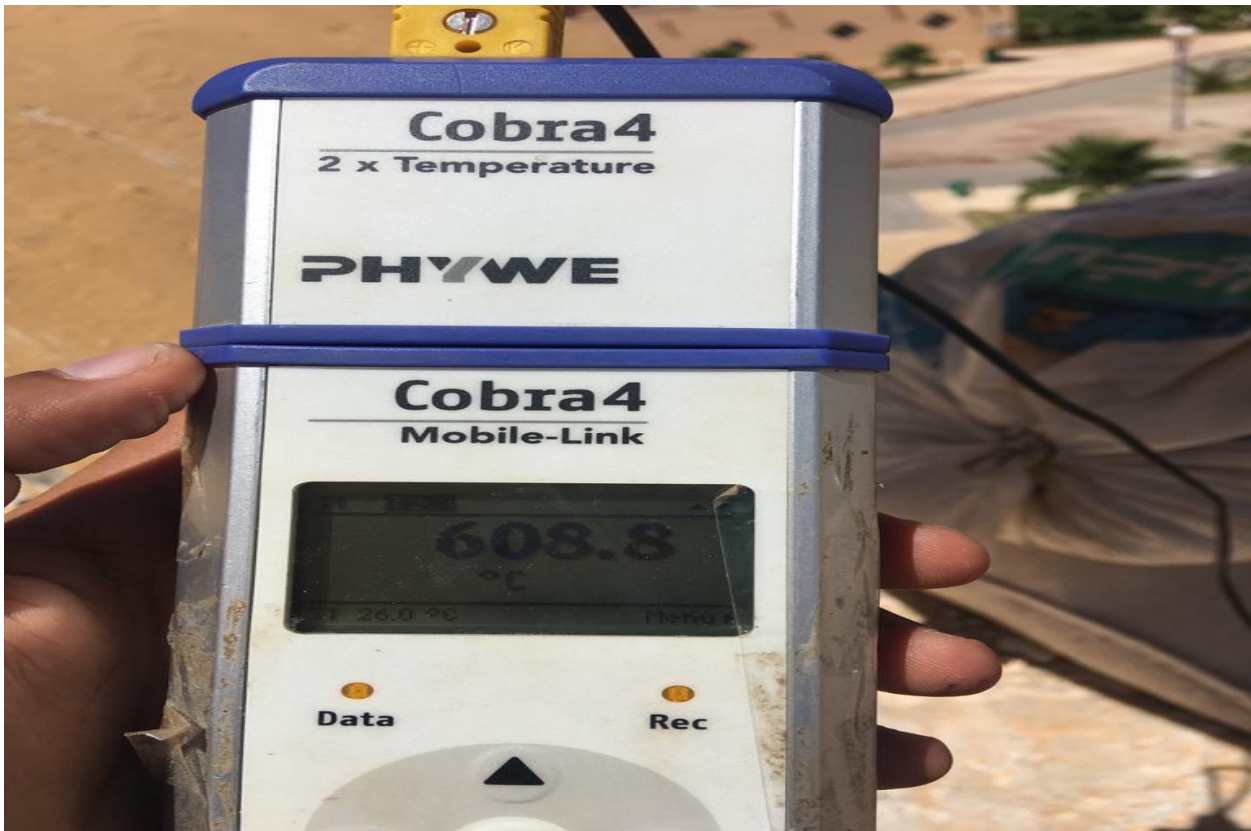
الشكل II-27: موقف (موضع) المقياس الحراري (توضح قراءة درجة الحرارة)
