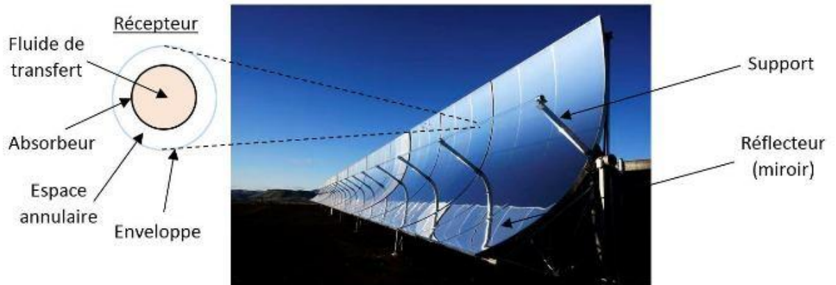
Figure I.7: Description d'un collecteur cylindro-parabolique
