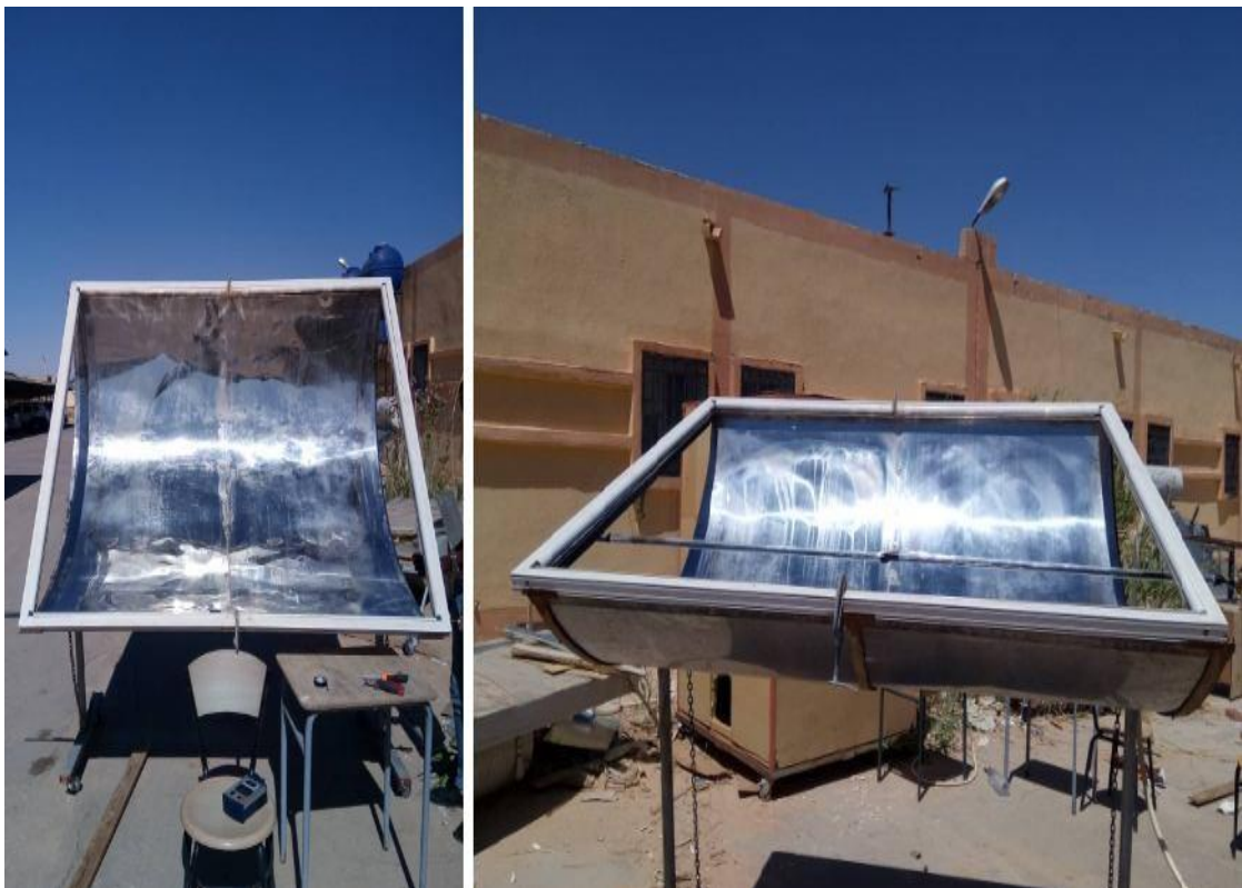
Figure III.7 : Utilisation de système de poursuite manuel
