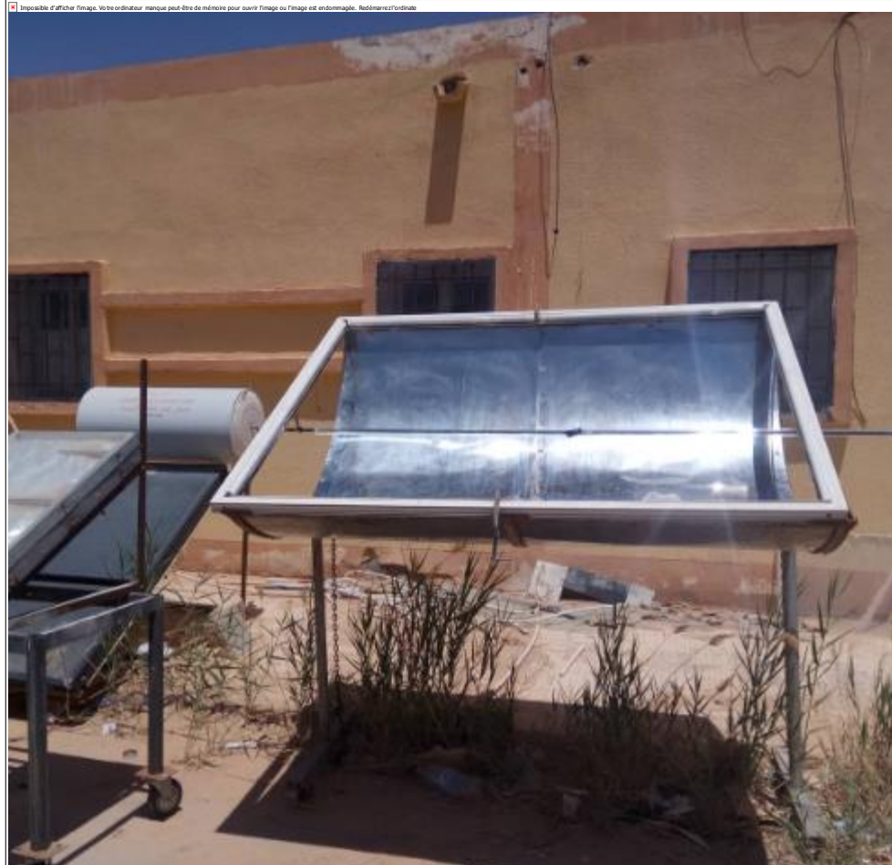
Figure III.8 : Positionnement de concentrateur vers le sud à 30^\circ
