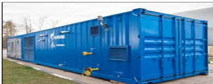
Fig. I.5. Unité de production d'azote
