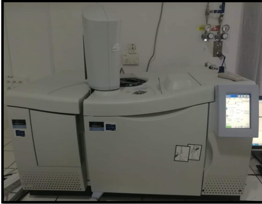
الشكل (I-17): صور لجهاز كروماتوغرافيا الغاز المرفقة بمطيافية الكتلة
