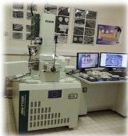
Figure 18 : Microscope électronique à balayage.
