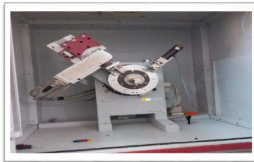
Figure 17 : Un Spectromètre XRD 3003 TT ;SEIFERT.
