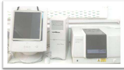
Figure 15: Un spectromètre FTIR de type SHIMADZU.
