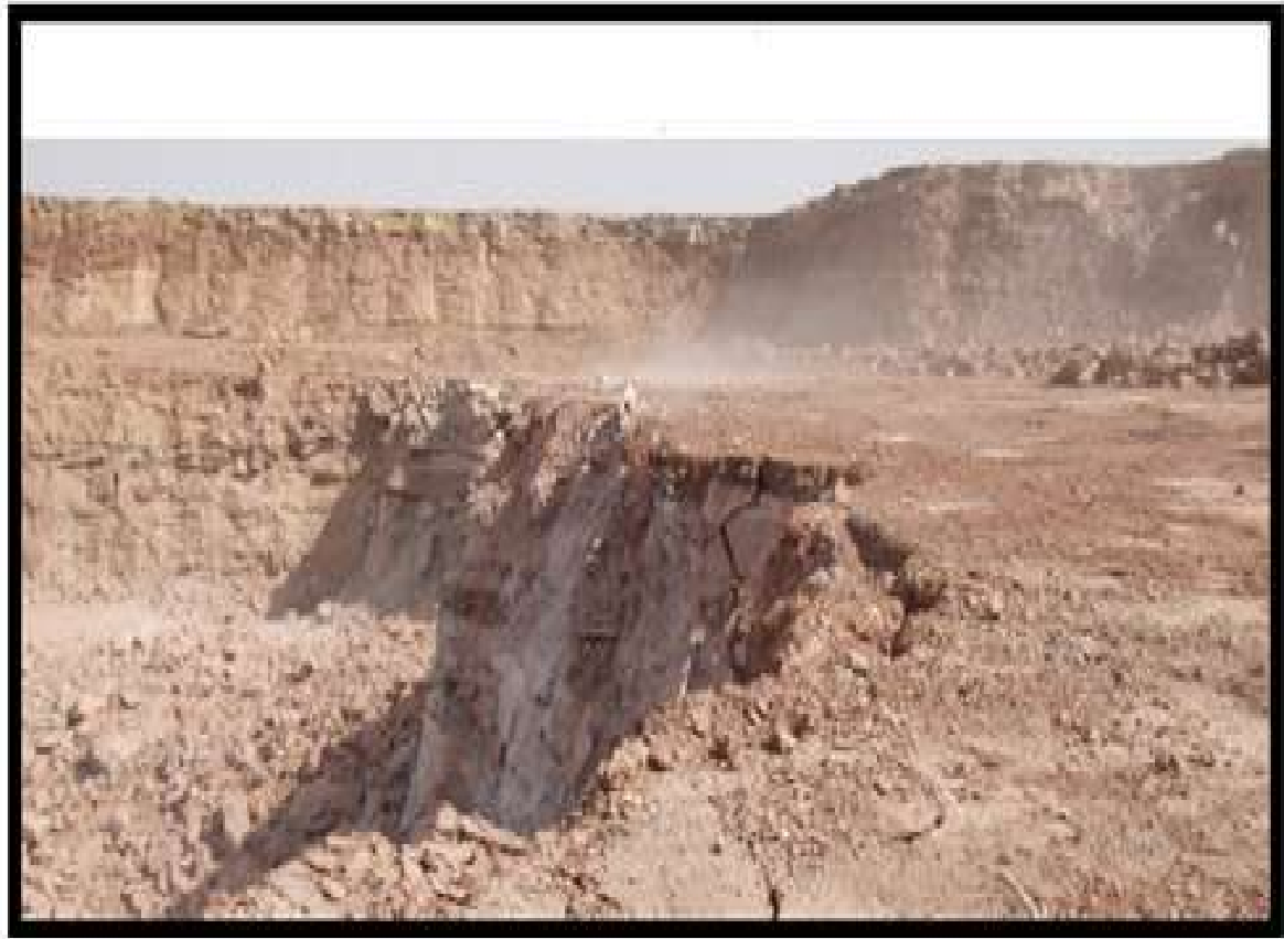
Figure I.12. Effet arrière constaté pour les essais bi-trous et multi-trous. [15]
