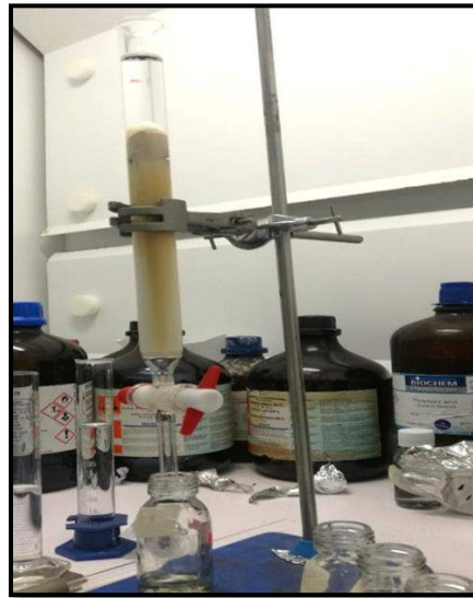
الشكل (25): تقنية كروماتوغرافيا العمود
