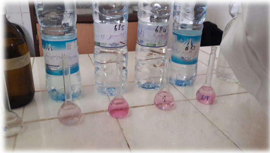
الشكل رقم (17) : يمثل صورة للعينات بعد اضافة المحلول المنظم للكشف عن النترت
