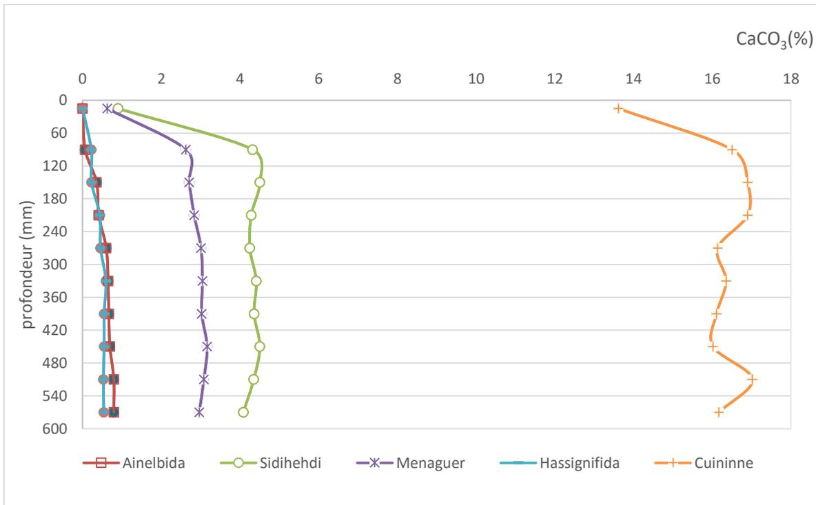
Figure II-9: Distribution verticale de (% $\text{CaCO}_3$ ) après le fonctionnement
