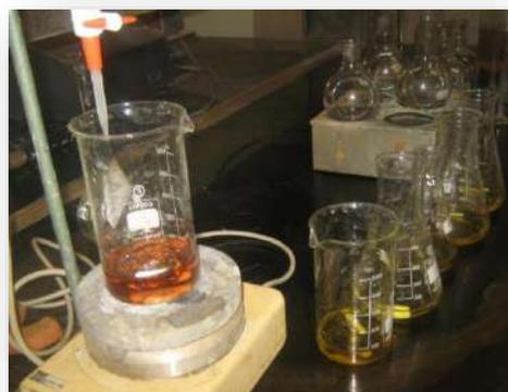
La demande chimique en oxygène (DCO) est la quantité d'oxygène consommée par les matières existant dans l'eau et oxydable dans des conditions opératoires définies. On fait la mesure correspond à une estimation des matières oxydable présentent dans l'eau quel que soit leurs origine organique ou minérale (fer ferreux, nitrites, ammonium, sulfate et chlorures).
