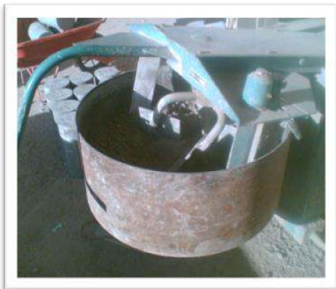
Photo A1-3 Malaxeur à Béton
