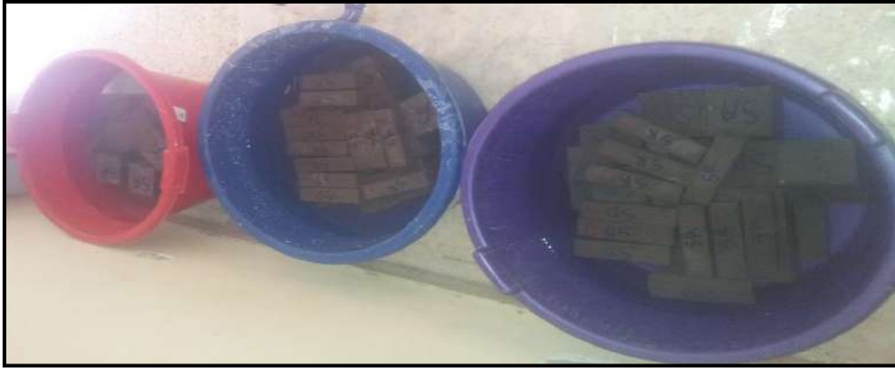
Figure IV-26 : Conservation des éprouvettes exposées à des milieux agressifs
