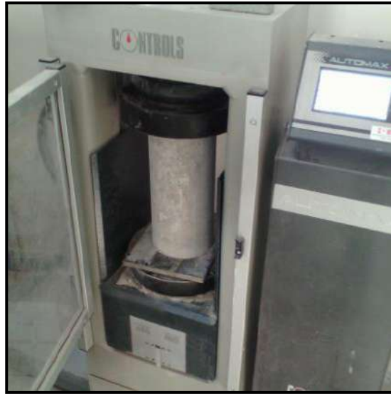
Figure (II-4) :Appareil pour Mesure la résistance de compression. annexe(A1-7)
