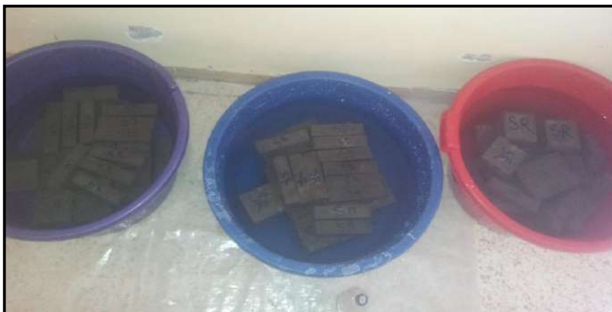
Figure IV-18 : Conservation des éprouvettes exposées à des milieux agressifs
