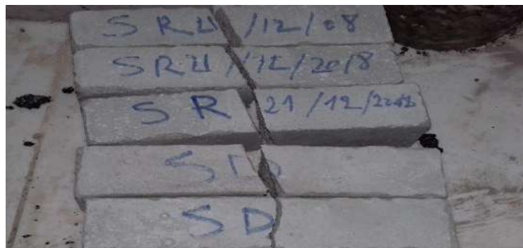
Photo A1-13 Eprouvettes écrasé traction par la flexion
