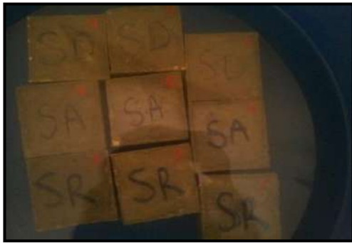
Figure IV-19: cure des éprouvettes sous l'eau
