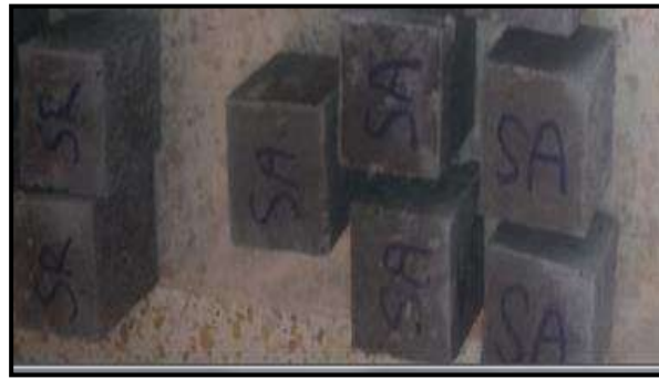
Figure IV-20:préparation des éprouvettes pour la pesé
