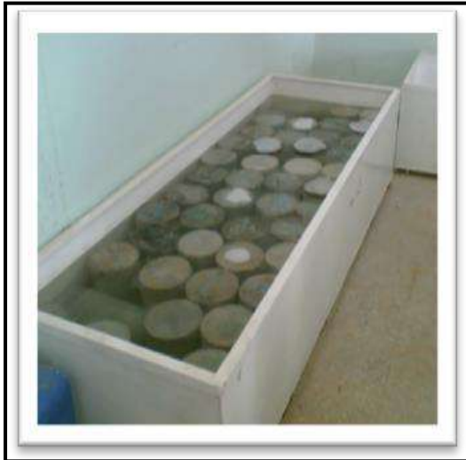
Photo A1-5 Conservation des éprouvettes à l'eau.
