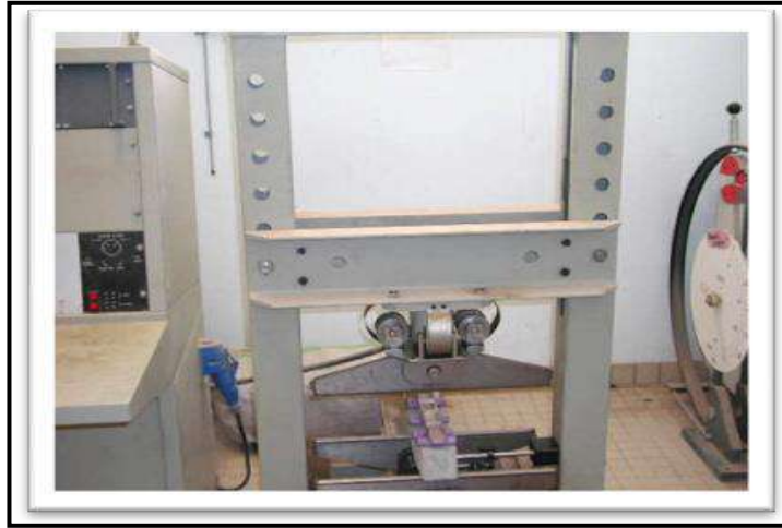
Figure (II-5) :Appareil pour Mesure la résistance de traction par flexion
