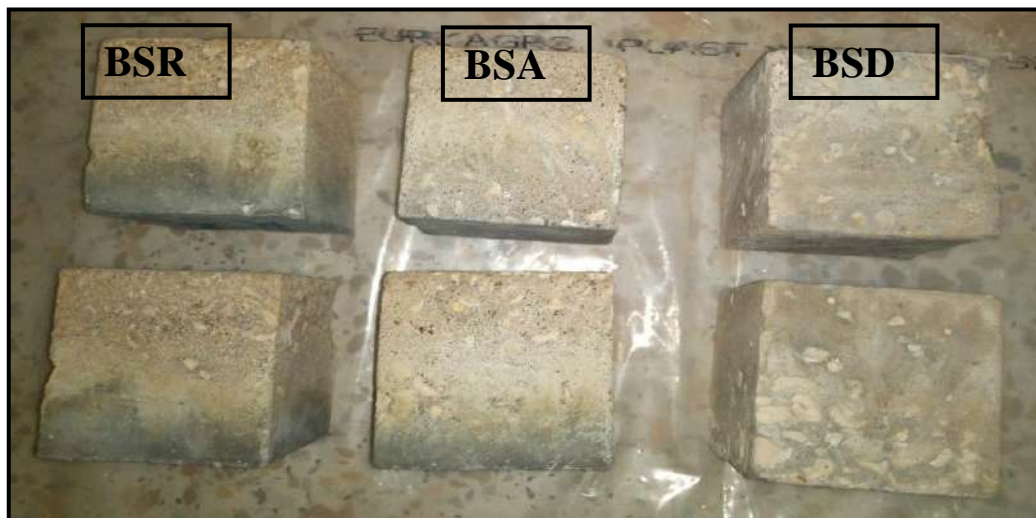
Figure V- 22 Etat des éprouvettes aux différents types du immergés dans Hcl
