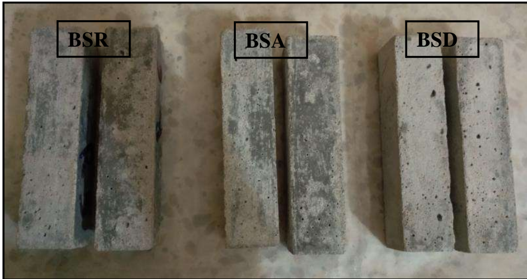
Figure V- 35 Etat des éprouvettes aux différents types des mortiers immergés dans \text{Na}_2\text{SO}_4
