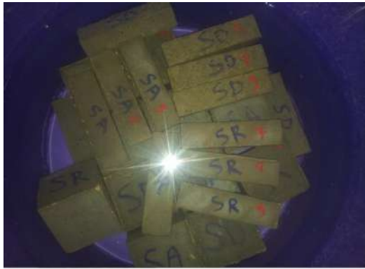
Figure IV-27: cure des éprouvettes sous l'eau
