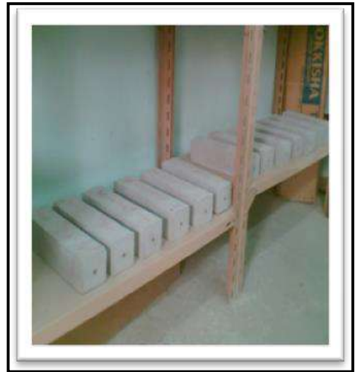
Photo A1-6 Conservation des éprouvettes à l'air libre.
