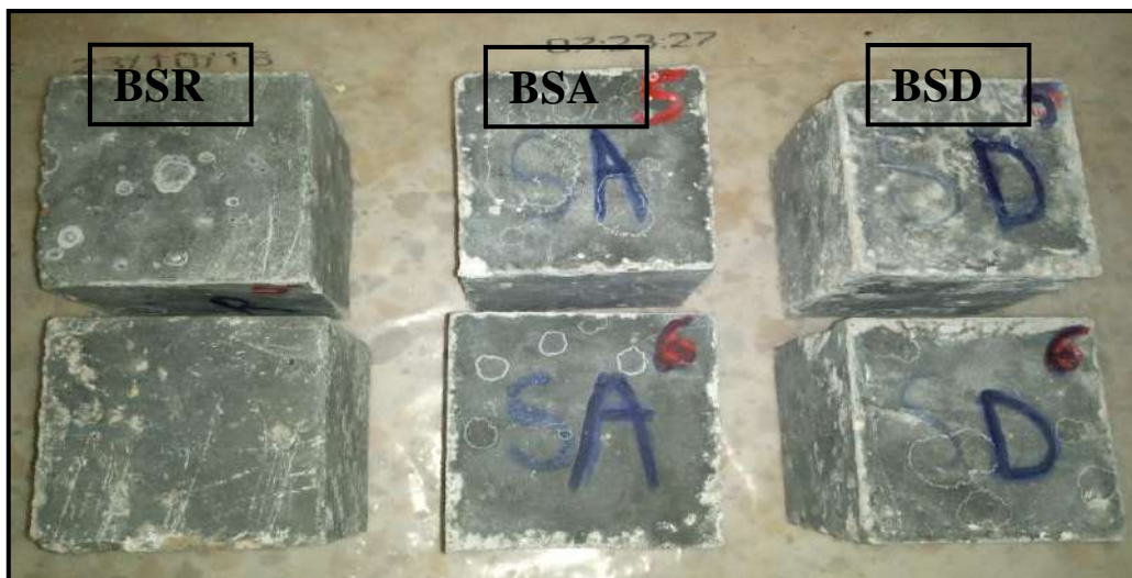
Figure V-20 Etat des éprouvettes aux différents types du bétons après leur immersion dans l'eau sans traité avec des attaques chimiques
