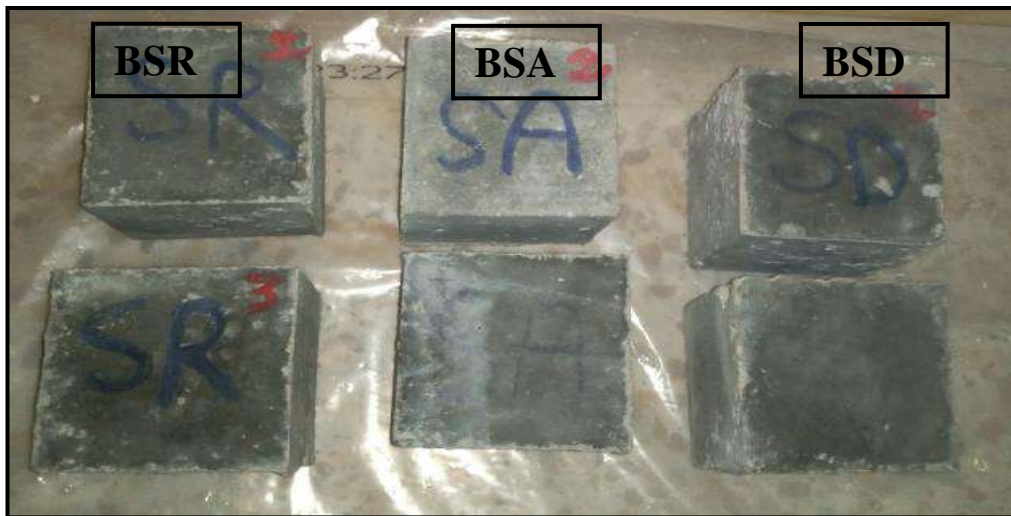
Figure V-20 Etat des éprouvettes aux différents types du bétons après leur immersion dans l'eau sans traité avec des attaques chimiques
