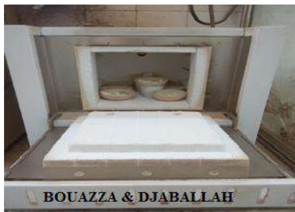
Photo 10. Dosage de gypse (Méthode de calcination au four à moufle)
