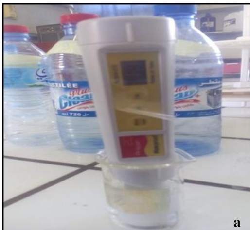
Figure 05: Mesure du (a) Potentiel Hydrogène pH et de (b) la Conductivité électrique CE
