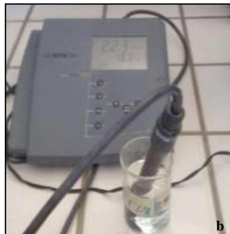
Figure 05: Mesure du (a) Potentiel Hydrogène pH et de (b) la Conductivité électrique CE
