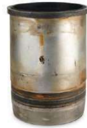
Figure III-28 : Dommages au niveau de la chemise
