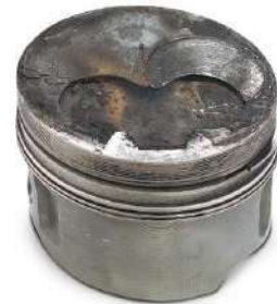
Figure III-10 : Traces de chocs
