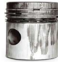
Figure III-9 : Dommages de la tête de piston
