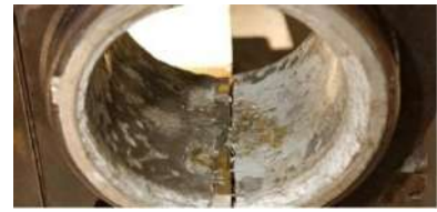
Figure III-17 : Une bielle fissurée
