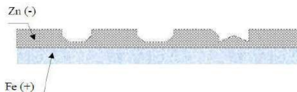
Figure 1.10 Revêtement anodique (cas du zinc sur fer) [1].
