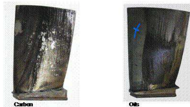
Fig.1.13 : Encrassement sur une aube de compresseur
