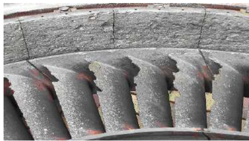
Fig.1.10 : Turbine à gaz dommages de FOD
