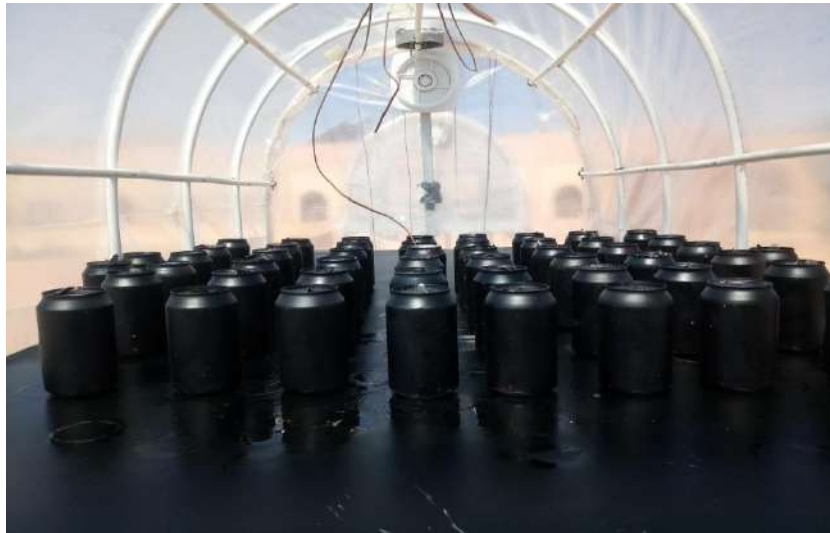
Figure III-5 : Configuration géométrique du système de stockage de la cire de paraffine sous serre.
