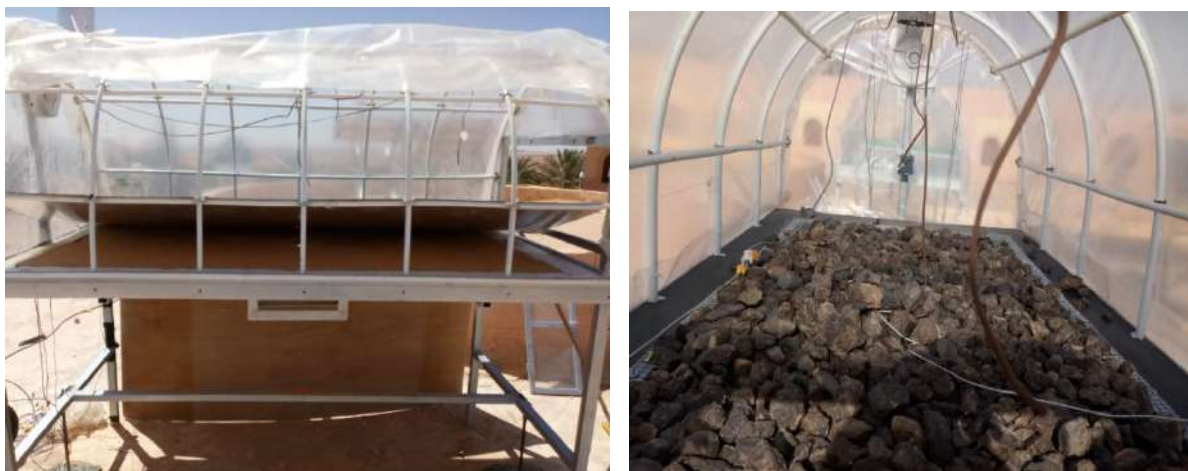
Figure IV-4.1: prototypes de séchoir solaire de type serre avec lit de sable (gauche) et avec lit de roche (droite)
