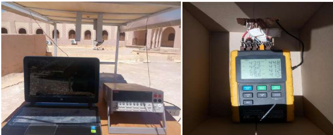
Figure III-8 : Photographie du séchoir solaire équipé avec la centrale de mesure
