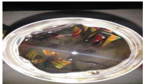
Bandes d'aluminium obtenues à partir de canettes jetables
