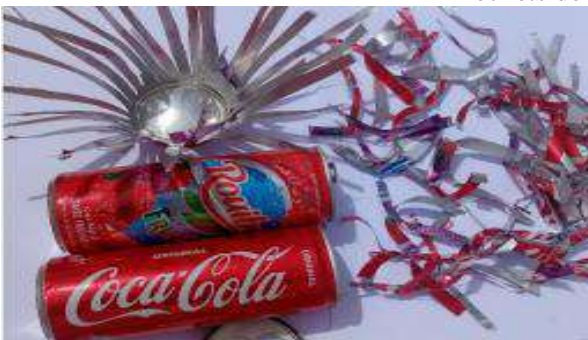
Bandes d'aluminium obtenues à partir de canettes jetables
