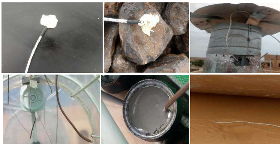
Figure III-6 photographies du capteur lors de la phase d'instrumentation.
