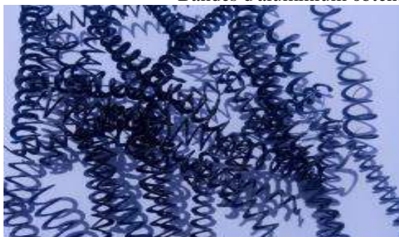
Copeaux acier en spirale tordus
