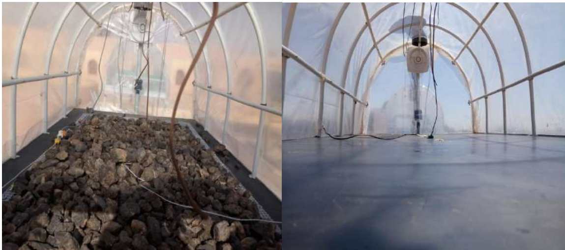
Figure IV.3.1: prototypes de séchoir solaire de type serre avec (gauche) et sans (droite) système de stockage
