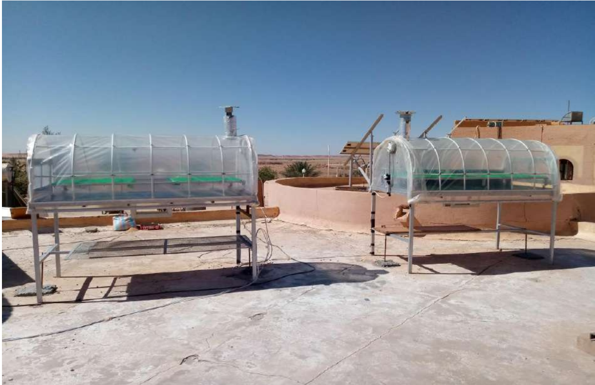
Figure III-15 : Prototype utilisé pour le séchage de menthe, courgette et betterave.
