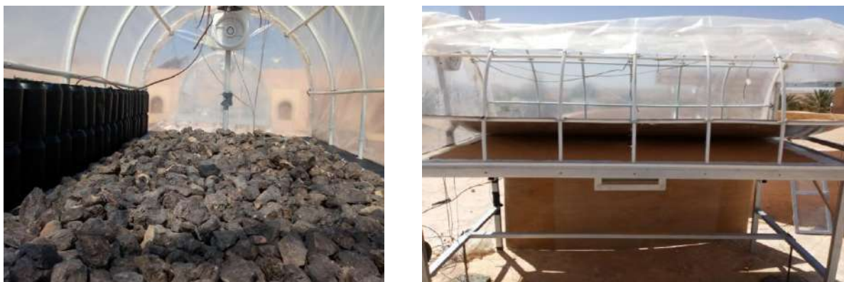
Figure IV.6.1: prototypes de séchoir solaire de type serre avec de paraffine wax + un lit de roche (droite) et avec lit sable (gauche)
