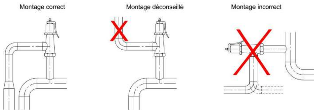
Figure III.3 : montage de la soupape de sécurité exacte.
