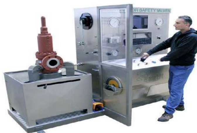
Figure II.1 : banc d'essai multi paramètre pour tester soupape de sécurité hydraulique.
