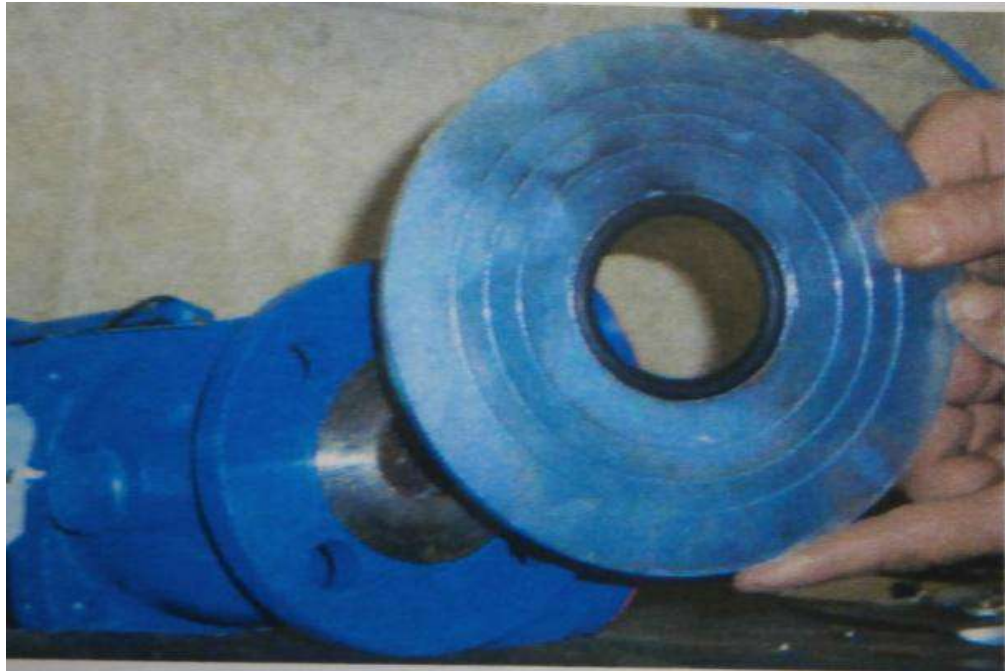
Figure III.5 : la plaque d'étanchéité de joint torique
