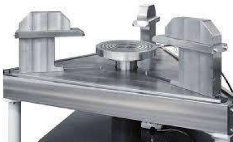
Figure II.3 : Dispositif de serrage manuel
