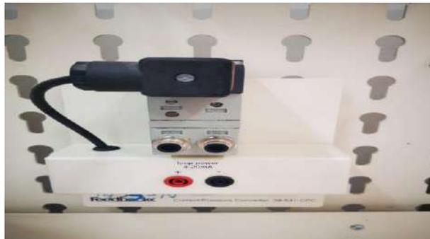
**Figure III.4:** *Convertisseur Courant /Pression 38-541-CPC [12].*
