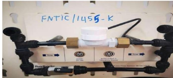
**Figure III.5:** Capteur de débit en impulsion 38-541-PFS.
