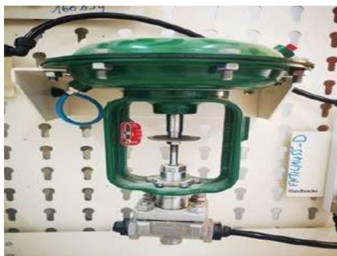
**Figure III.6 :** Vanne de commande 38-541-CV.
