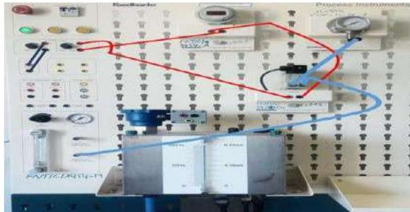
**Figure IV.7 :** Montage pour l'étalonnage de convertisseur Courant /Pression 38-541-CPC [7].
