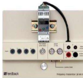
Figure III.2 : Transmetteur de fréquence (SMART) 38-541-FT [12].
