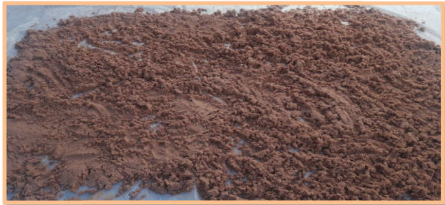
Figure 6 : Séchage du sable à l'air libre
