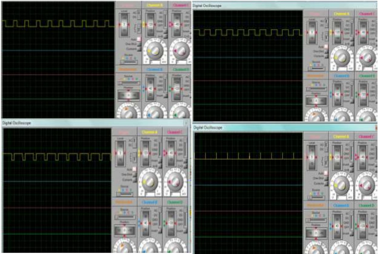
Figure III. 6: Signal de commande PWM.
