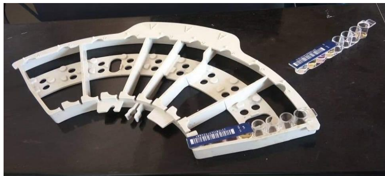
Photo 04. Emplacement des barrettes test dans les « Sys Trays ».
