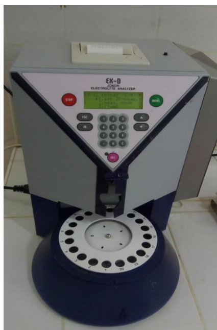
Figure 10 : Ionogramme (EX-D Jokoh ELECTROLYTE ANALYZER) pour le dosage de Na, K, Cl.
