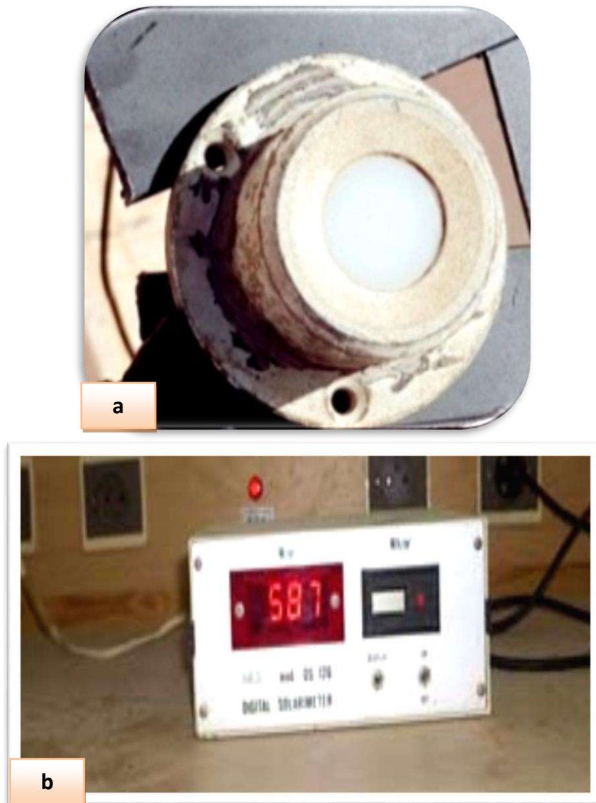
Figure (II-6) Parties de Pyromètre: a) capteur de radiation solaire b) afficheur numérique
