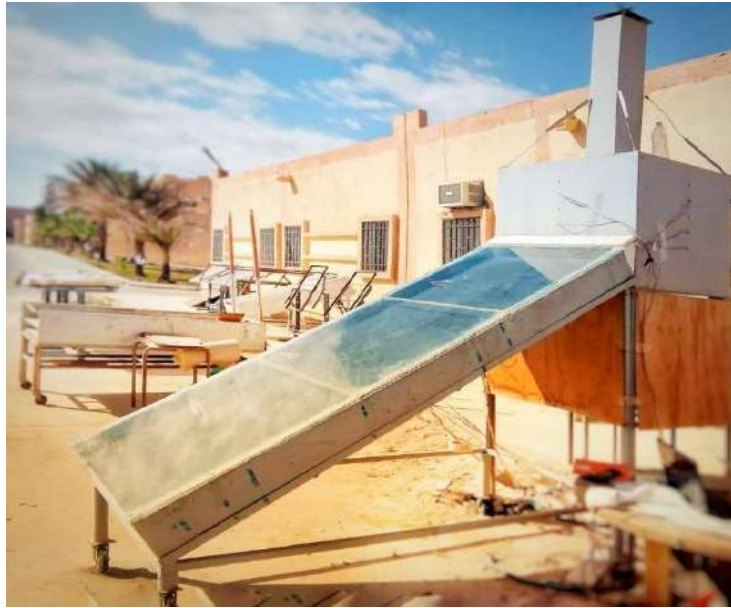
Figure II.2: Séchoir solaire indirect réalisé par le laboratoire (LENREZA) univ. Kasdi Merbah Ouargla
