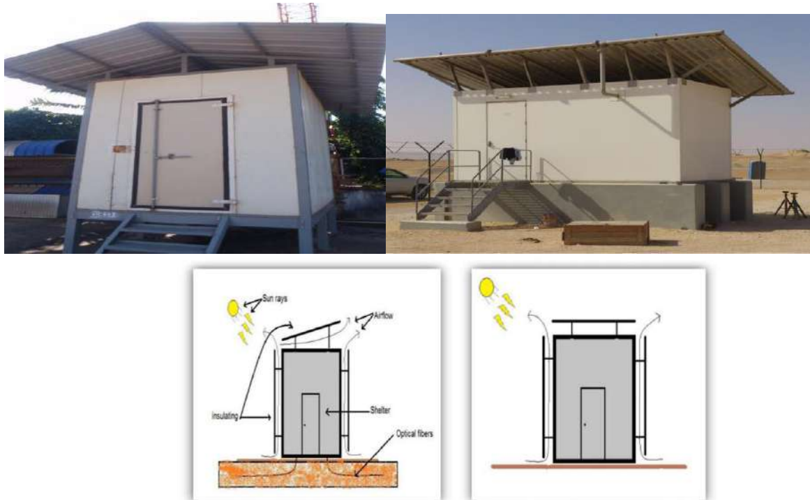
Figure (I.10) :L'isolation thermique des parois externes.
