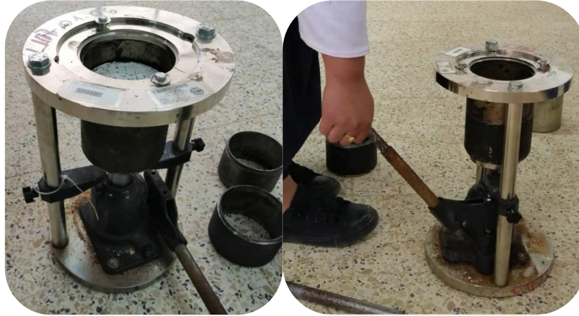
Photo. V.4:Opération de démoulage.
