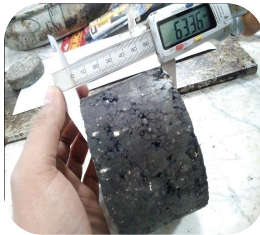
Photo. V.7: Mesure des dimensions avec le pied à coulisse.
