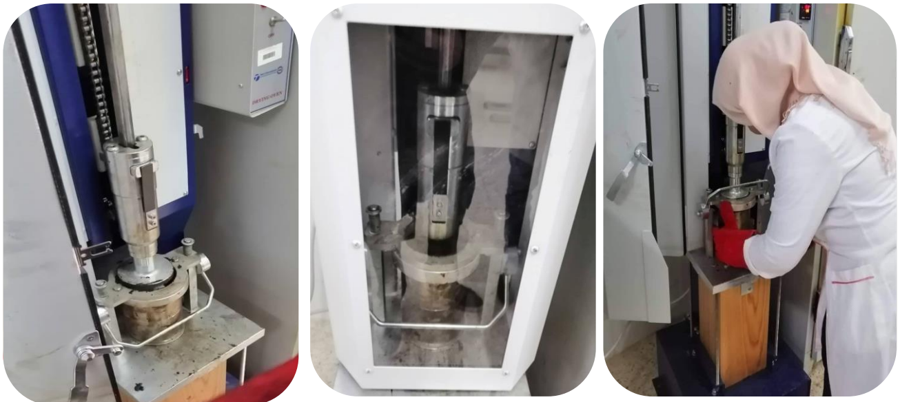
Photo. V.3: Opération de compactage.
