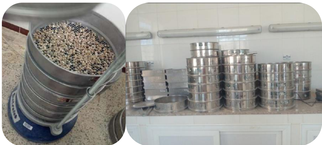
Photo. IV.4: Tamis d'analyse granulométrique.
