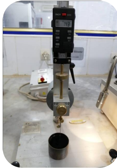
Photo. I.1: Essai de Pénétrabilité.
