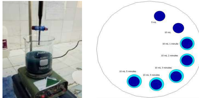
Fig. IV.3: Procédure de l'essai bleu méthylène.
