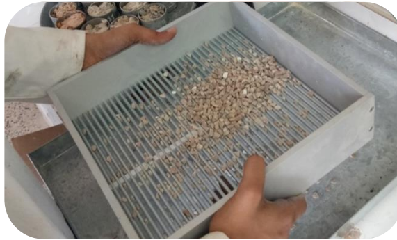
Photo. IV.5: Principe de l'essai d'aplatissement.
