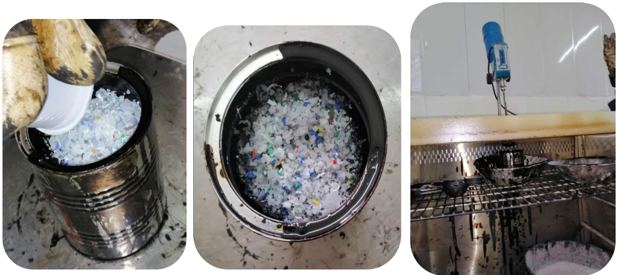
Photo. V.2 : Modification du bitume par le PEBD.
