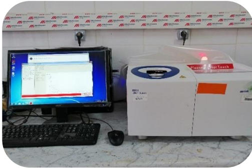
Photo. IV.9: L'équipement de Differential Scanning Calorimetry.
