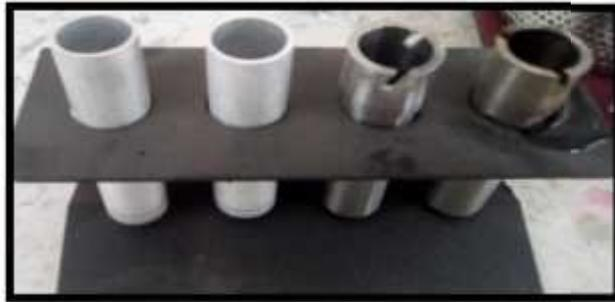
Photo V.10. Les tubs viscosimètre (Brookfield) avec le bitume.
