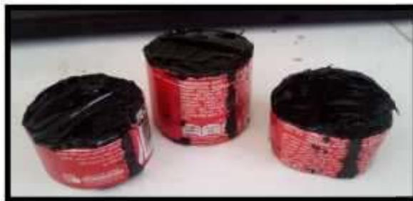
**Photo V.9. Eprouvettes de l'essai stabilité au stockage.**
