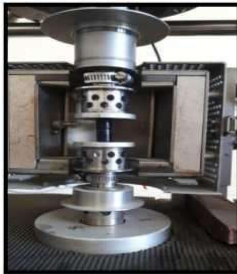
Photo V.13. Dispositif de l'essai DMA par le Métravib.
