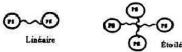
**Figure III.1. Configuration des molécules de SBS[2].**
