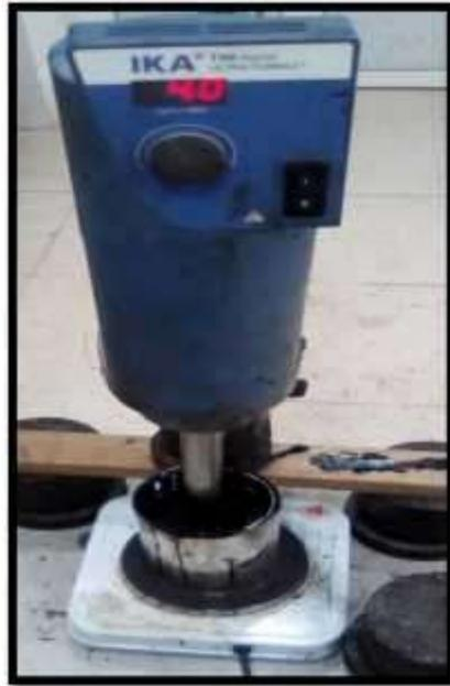
Photo V.3. Modification du bitume pur.
