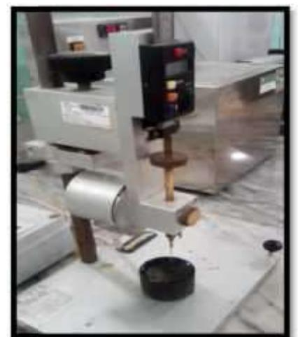
Photo IV.1. Pénétromètre.
