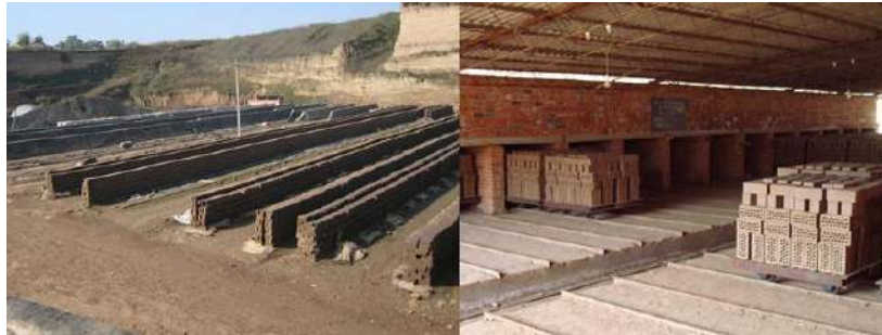
Figure I.14. A gauche: Séchage à l'air libre. Adroite: Séchage artificiel[29]
