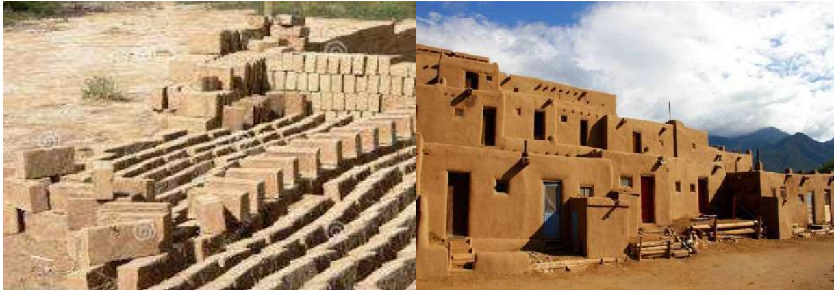
Figure I.1. A gauche : des adobes au séchage sous le soleil [3]. A droite : une construction en adobes [4]
