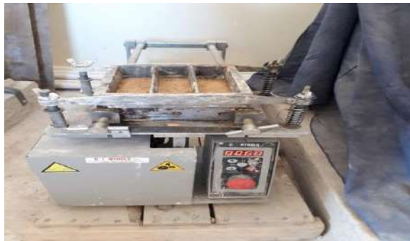
Photo A20 : compactage des éprouvettes
