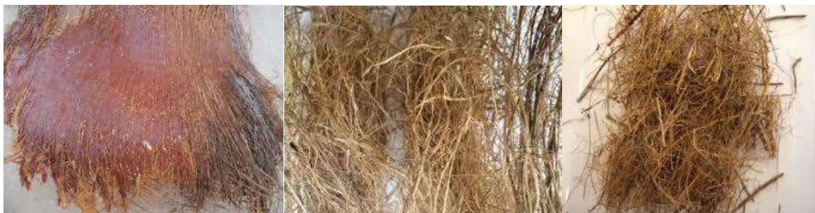
Figure II.12: Le lif après son Figure II.13: Les fibres résultant. Figure II.14: Les fibres arrachement du palmier dattier. de la décomposition du lif. découpées en morceaux.
