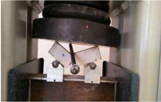
Figure III.1 : Dispositif pour l'essai de traction par flexion
