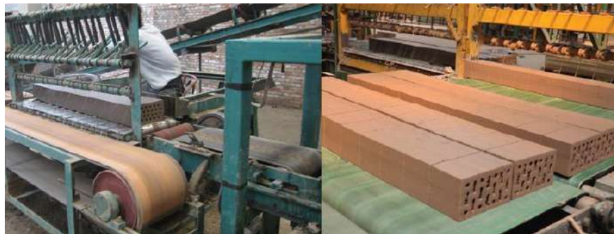
Figure I.13. Moulage ou façonnage[28]
