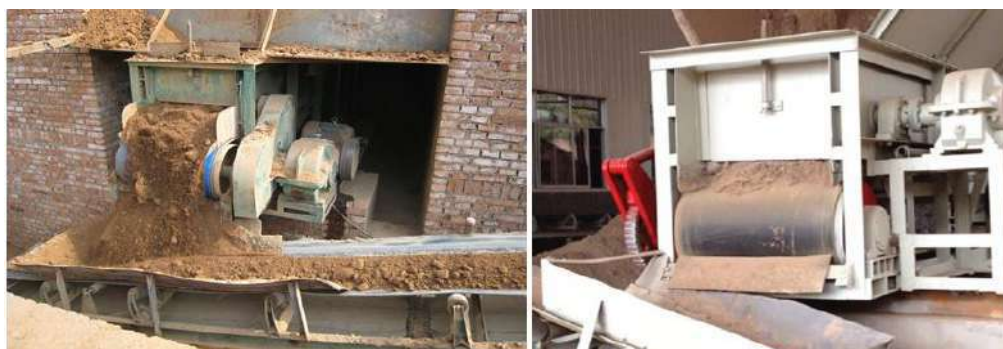
Figure I.12. Broyage et malaxage de l'argile [26] [27]
