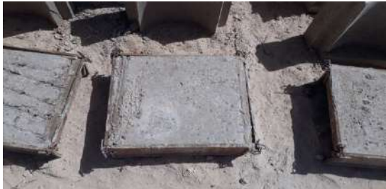
Demoulage les briques de timchemt
