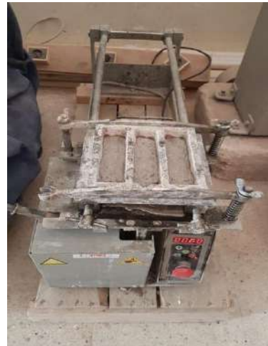
Figure III.4 compactage des éprouvettes à l'aide d'une table à chocs
