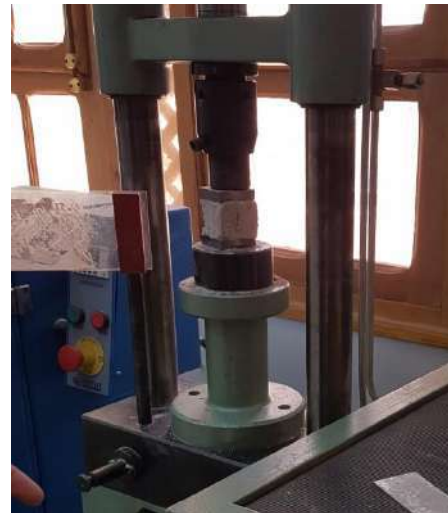
Figure III.10 Dispositif pour l'essai de compression
