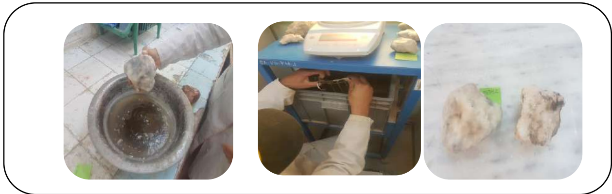
Figure II.7 Essai de la densité naturel.
