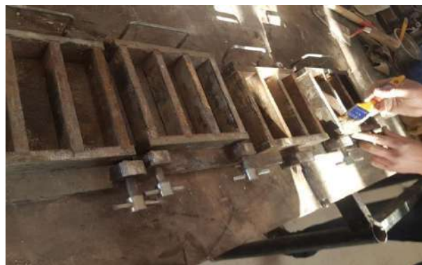
Figure III.2 huilage des moules
