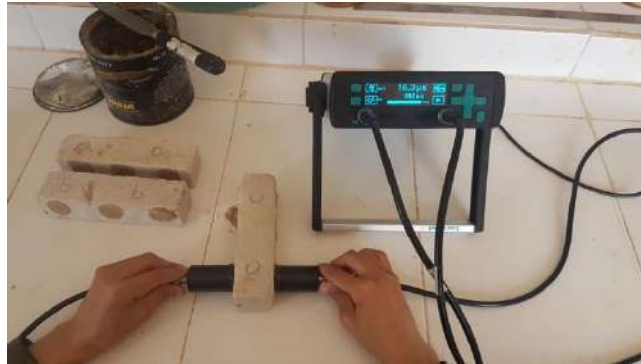
Figure III.12 Dispositif pour l'essai ultrasonique
