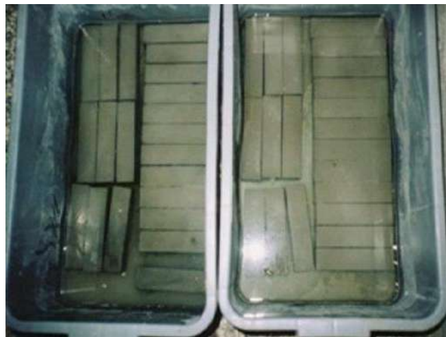
Figure III.17 conservation des éprouvettes dans l'eau potable et l'eau agressive
