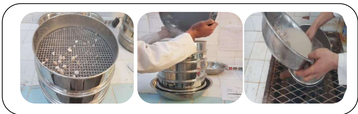
Figure II.1 Essai d'analyse granulométrique par tamisage.
