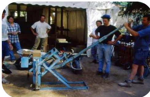
Figure I.6 Bloc de terre comprimée réalisée à l'aide d'une presse manuelle [9]
