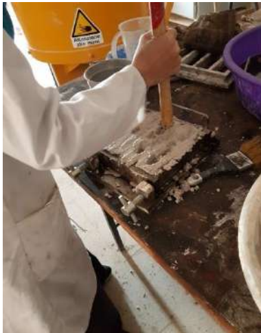
Figure III.4 compactage des éprouvettes à l'aide d'une table à chocs
