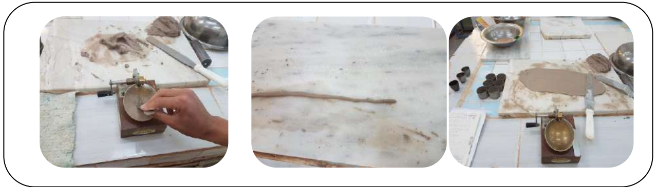
Figure II.6 Essai de limites d'Atterberg.
