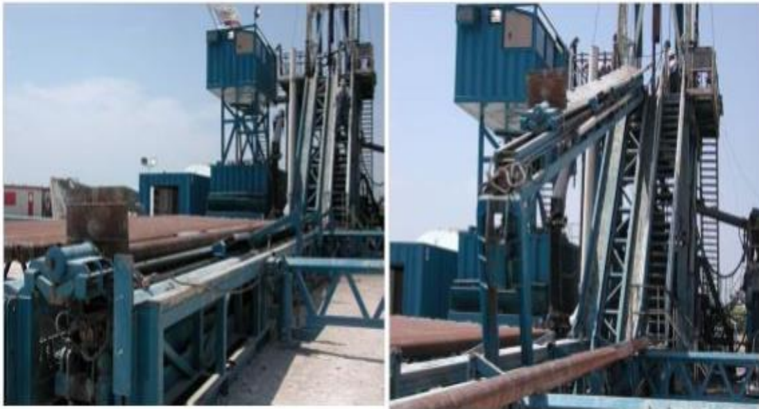
Fig. II.4 Le Power Catwalk pour le tubage encours de forage
