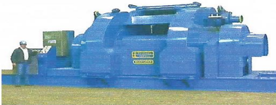
Fig. I. 4 Le treuil de forage
