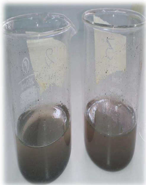
Figure 11 : Ajouter de l'eau distillée à la poudre et mélanger
