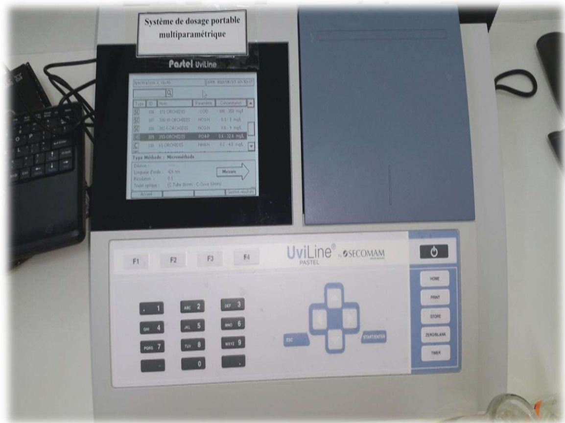
Figure 13: Appareille de système de dosage portable multiparamétrique
