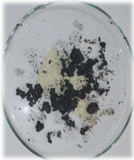
Figure 9: Sécher la boue-dans Étuve dont la température à 105 °C
