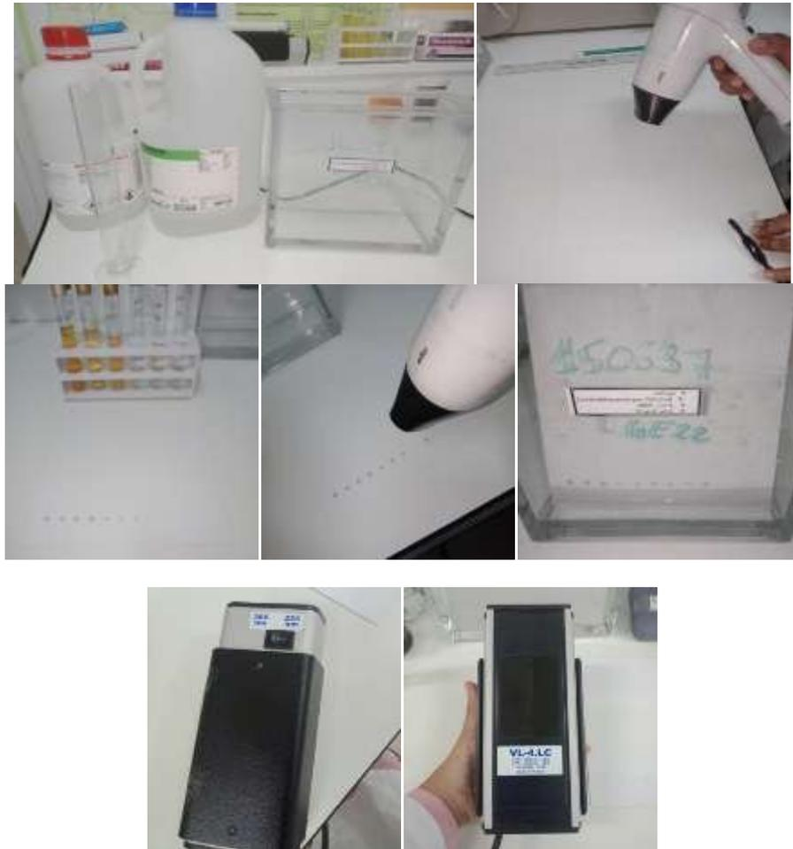
Etapes de préparation et de lecture des résultats de la CCM Tests avec différents solvants A.Acétate d'éthyle méthanol
