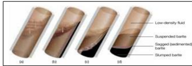
Figure I.8: Baritesag affecté par les propriétés du fluide. [6]
