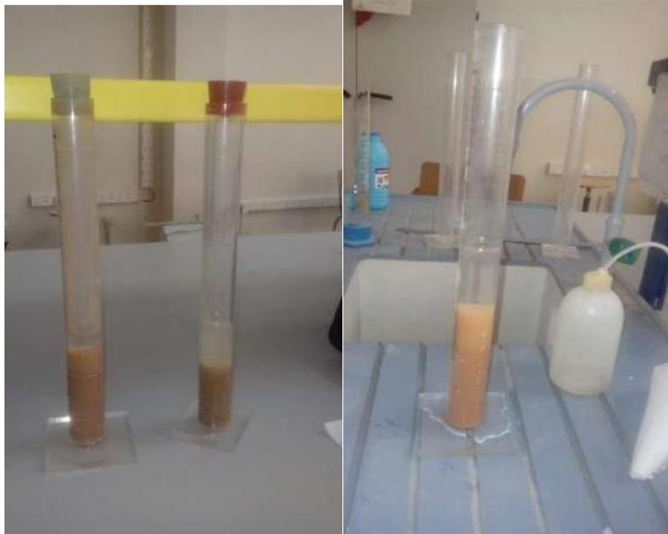
Photo II.3. Essai équivalent de sable
