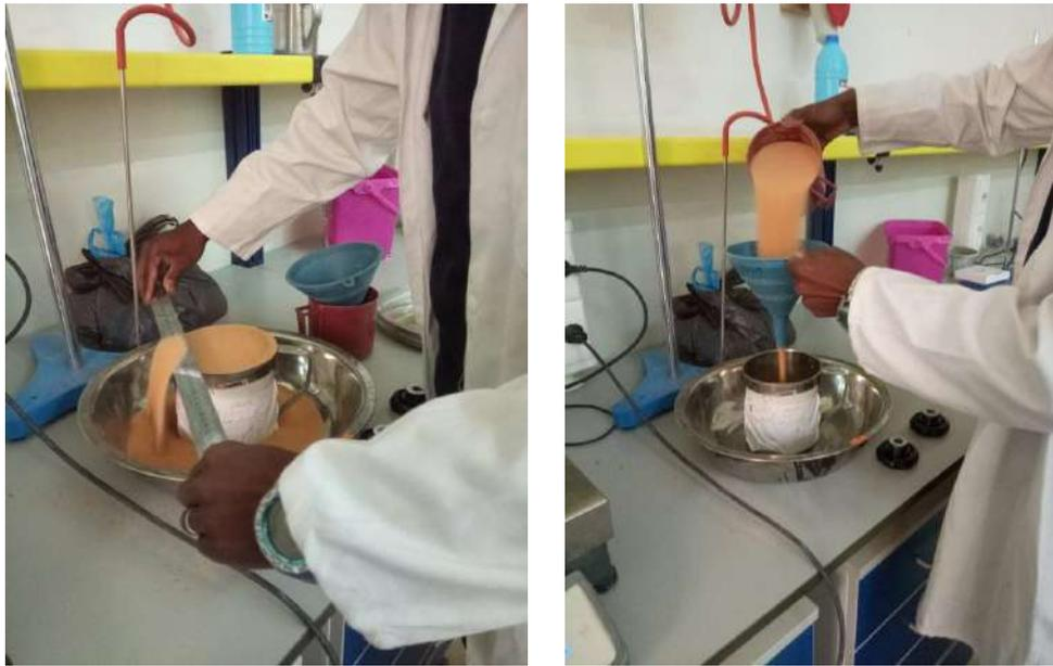
Photo II.2. Essai de Masse volumique apparente
