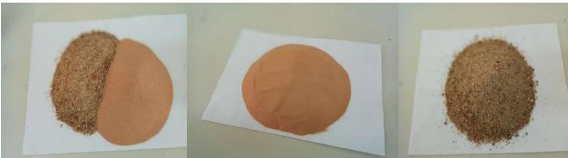
Photo .A.5 : l'essai granulométrique
