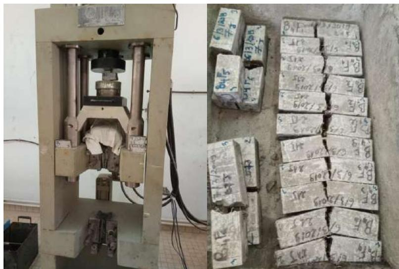
Photo III.2: Essai de résistance à la compression
