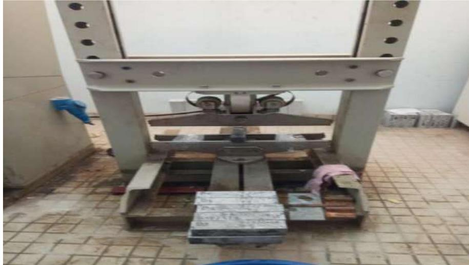
Photos III.1. Essai de résistance à la flexion (3 points)
