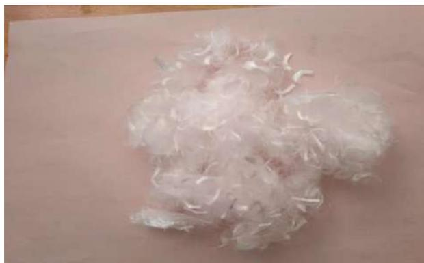
Photo II.6 : La géométrie de fibres polypropylène utilisé
