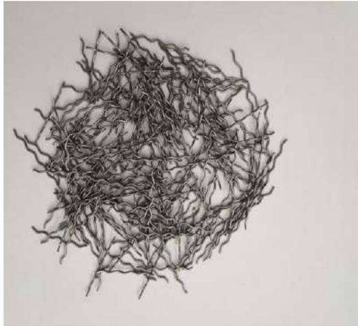
Photo II.5 : La géométrie de fibres métalliques utilisées
