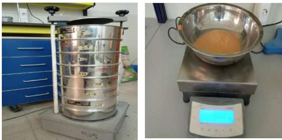
Photo II.4. Essai d'analyse granulométrique
