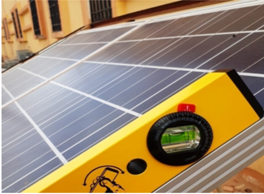
شكل III-3 : جهاز لتحديد زاوية ميل الألواح الشمسية.
