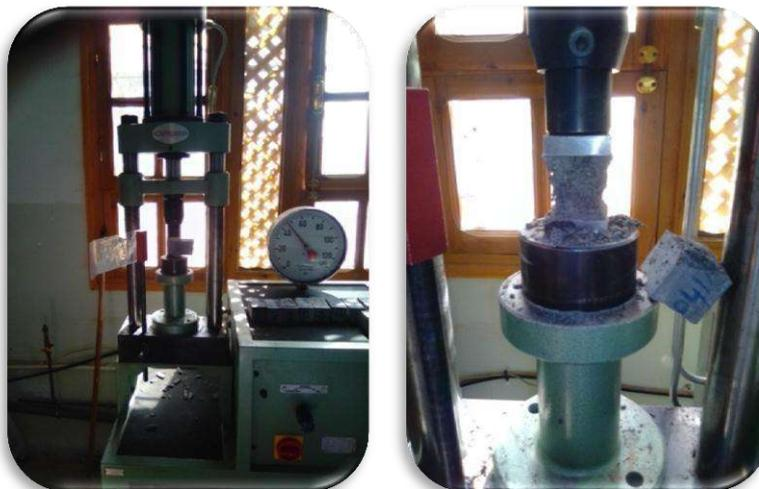
Photo 5 : Essai de compression
