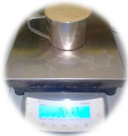
Figure II- 5 : Essai la masse volumique apparente.
