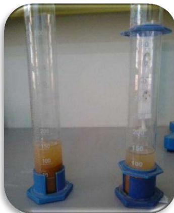
Figure II- 4 : essai la masse volumique absolue.
