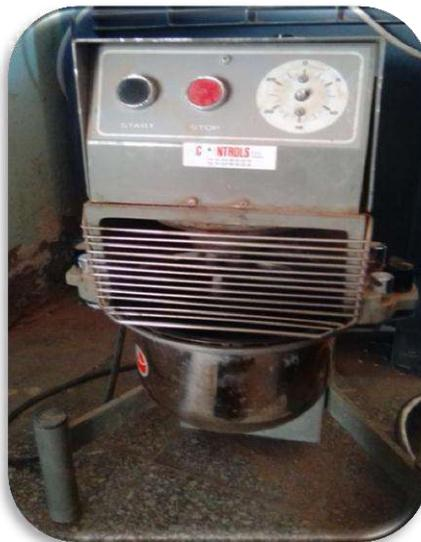
**Figure II- 7 : malaxeur de mortier**
