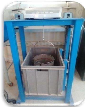
Figure II- 15 : balancé hydrostatique
