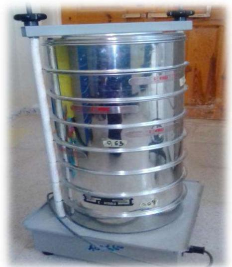
Figure II- 2 : Machine d'Analyse Granulométrique Par Tamisage.
