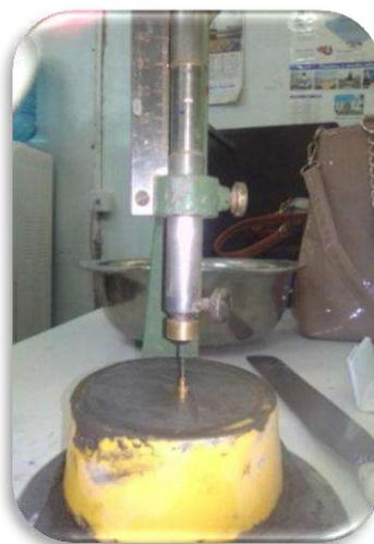
**Figure II- 10 : détermination du temps de fin de prise**
