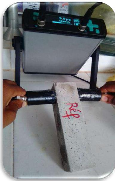
Figure II- 16 : essai de vitesse de propagation de son
