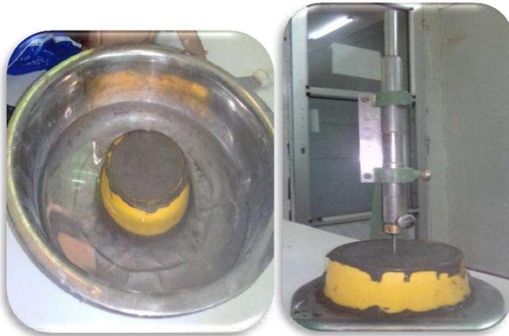
**Figure II- 9 : détermination du temps de début de prise**
