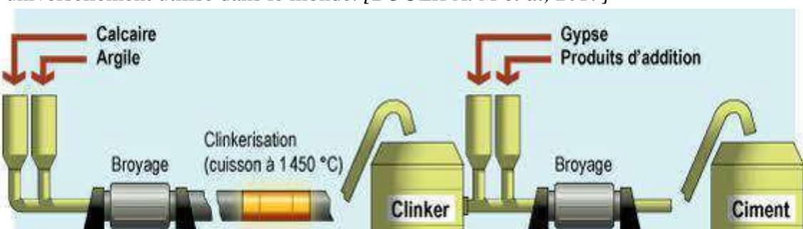
Figure I- 1 : fabrication de ciment
