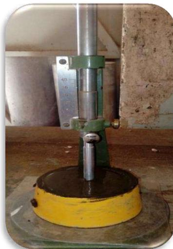
Figure II- 8 : essai de pénétration
