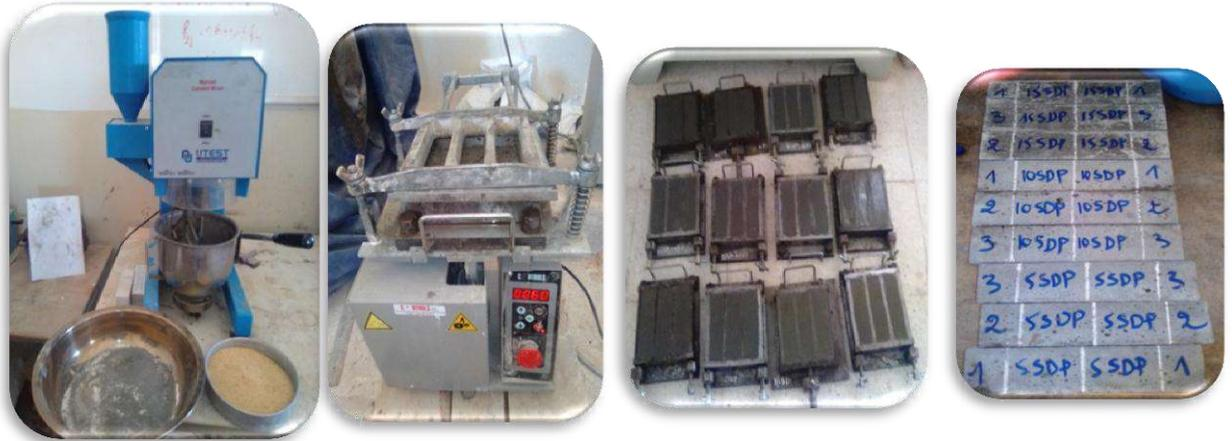
Photo 3 : Les étapes de préparations et collage de mortier
