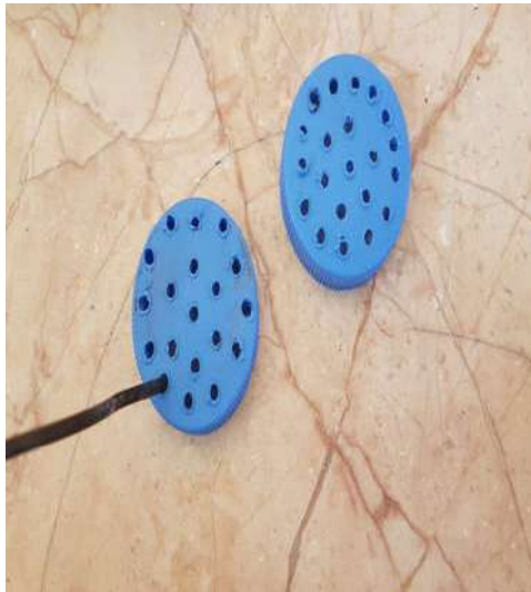
Photo III. 22 : Perçage des arroseurs
