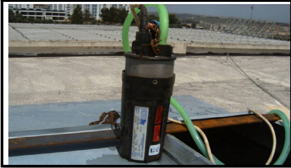
الشكل (3-4):يوضح المضخة المستخدمة(shurflo 9325)
