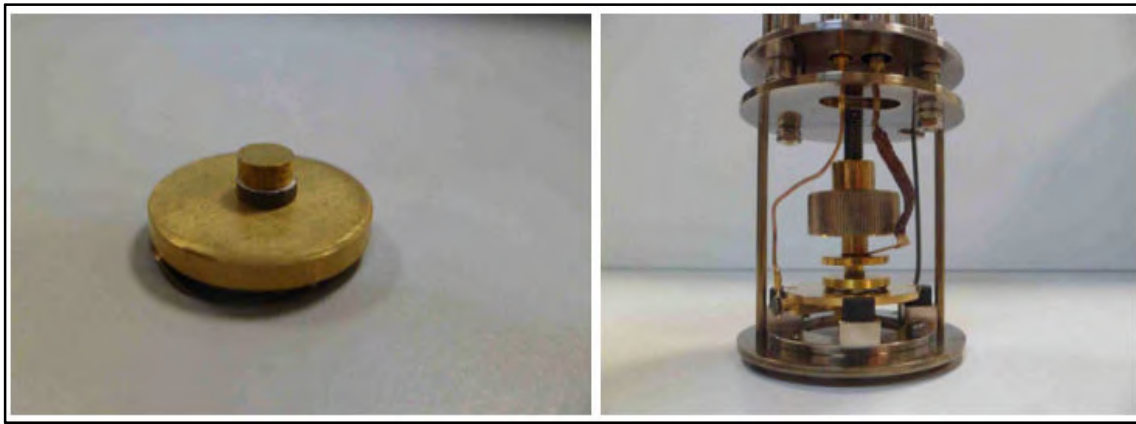
الشكل (III-8): خلية القياس المستعملة في جهاز قياس مطيافية الممانعة الكهربائية [25]
